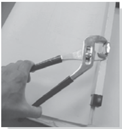
Algunas herramientas comunes, como estas pinzas, actúan como máquinas simples. Aquí, la fuerza aplicada sobre los mangos crea una fuerza más grande en las quijadas.
