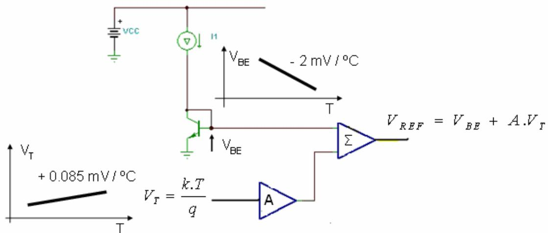
Recordando que  $V_{BE} = V_T \cdot \ln \frac{I_1}{I_S}$  (1) y  $V_T = \frac{K.T}{q}$  (2), siendo:
