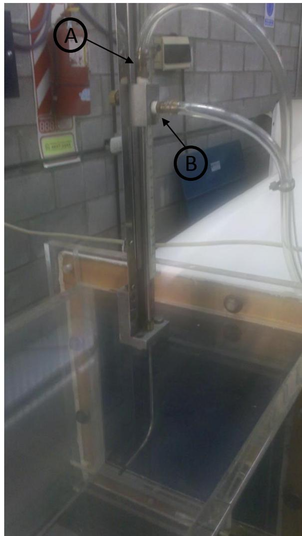
Figura 3.3.2: Tubo Pitot estándar usado en el laboratorio.
