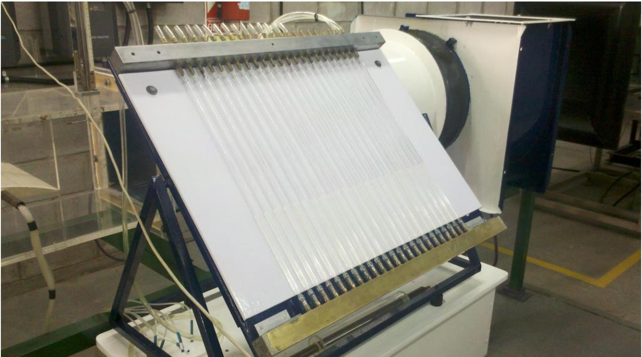
Figura 3.2.2: Manómetro diferencial usado en el laboratorio, nótese las múltiples columnas y la inclinación a 45°.
