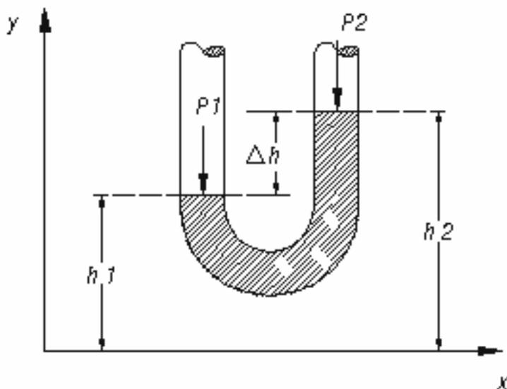
Figura 3.2.1: Manómetro diferencial, esquema básico y nomenclatura.
