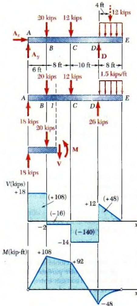
**Diagrama de fuerza cortante.** Como  $dV/dx = -w$ , se encuentra que la pendiente del diagrama de fuerza cortante es igual a cero (esto es, que la fuerza cortante es constante) entre cargas concentradas y reacciones. La fuerza cortante en cualquier punto se determina dividiendo la viga en dos partes y considerando a cualquiera de dichas partes como un cuerpo libre. Por ejemplo, utilizando la porción de la viga que está a la izquierda de la sección 1, se obtiene la fuerza cortante entre B y C:
