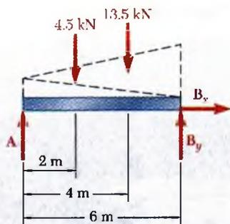
b) **Reacciones.** La reacción en A es vertical y se representa con A; la reacción en B está representada por sus componentes  $B_x$  y  $B_y$ . Como se muestra en la figura, la carga dada se puede considerar como la suma de dos cargas triangulares. La resultante de cada carga triangular es igual al área del triángulo y actúa en su centroide. Se escriben las siguientes ecuaciones de equilibrio para el cuerpo libre mostrado:
