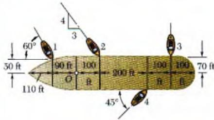
Se usan cuatro remolcadores para llevar a un trasatlántico a su muelle. Cada remolcador ejerce una fuerza de 5 000 lb en la dirección mostrada en la figura. Determine: a) el sistema equivalente fuerza-par en el mástil mayor  $O$  y b) el punto sobre el casco donde un solo remolcador más potente debería empujar al barco para producir el mismo efecto que los cuatro remolcadores originales.
