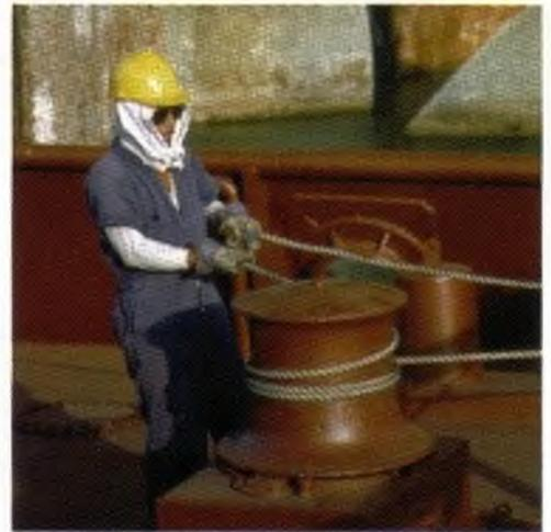
**Fotografía 8.3** Al enrollar la cuerda alrededor del bolardo, la fuerza ejercida por el trabajador para controlar la cuerda es menor que la tensión en la porción tirante de la cuerda.
