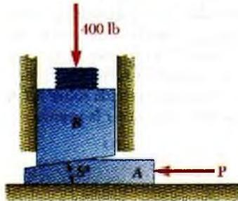
La posición del bloque *B* de una máquina se ajusta moviendo la cuña *A*. Si el coeficiente de fricción estática entre todas las superficies de contacto es 0.35, determine la fuerza *P* requerida para *a*) levantar al bloque *B* y *b*) bajar al bloque *B*.
