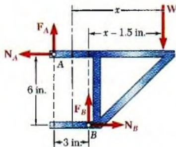
**Diagrama de cuerpo libre.** Se dibuja el diagrama de cuerpo libre de la ménsula. Cuando  $W$  se coloca a la distancia mínima  $x$  medida desde el eje del tubo, la ménsula está a punto de deslizarse y las fuerzas de fricción en  $A$  y  $B$  han alcanzado sus valores máximos:
