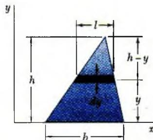
Se dibuja un triángulo de base  $b$  y altura  $h$ ; el eje  $x$  se selecciona de manera que coincida con la base del triángulo. Se selecciona  $dA$  como una tira diferencial paralela al eje  $x$ . Como todas las porciones de la tira están a la misma distancia a partir del eje  $x$ , se escribe
