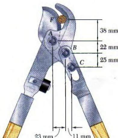
**6.146** Para cortar una pequeña rama colocada en  $F$  se usan tijeras podadoras, los mangos  $AD$  y  $BE$  pivotean respecto al perno  $B$  y la cuchilla  $AC$  pivotea respecto al perno fijo  $A$ , mientras que el perno  $C$  puede deslizarse libremente en la ranura del mango  $BE$ . Determine la magnitud de las fuerzas ejercidas sobre la rama cuando se aplican dos fuerzas de 250 N a los mangos, según muestra la figura.
