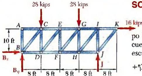
**Cuerpo libre: armadura completa.** Se dibuja un diagrama de cuerpo libre de toda la armadura; las armaduras externas que actúan sobre este cuerpo libre consisten en las cargas aplicadas y las reacciones en  $B$  y  $J$ . Se escriben las siguientes ecuaciones de equilibrio.
