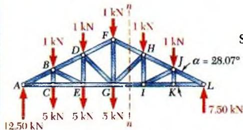
**Fuerza en el elemento  $GI$ .** Se pasa la sección  $nn$  a través de la armadura, como se muestra en la figura. Con el uso de la porción  $HLI$  de la armadura como el cuerpo libre, se obtiene el valor de  $F_{GI}$  al escribir
