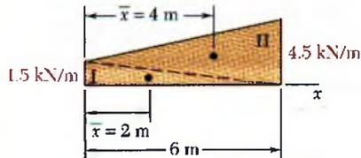
a) **Carga concentrada equivalente.** La magnitud de la resultante de la carga es igual al área bajo la curva de carga y la línea de acción de la resultante pasa a través del centroide de dicha área. Se divide el área bajo la curva de carga en dos triángulos y se construye la tabla que se presenta a continuación. Para simplificar los cálculos y la tabulación, las cargas por unidad de longitud dadas se han convertido a kN/m.
