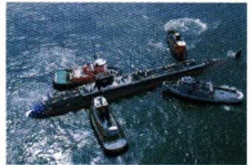
**Fotografía 3.4** Las fuerzas coplanares ejercidas por los cuatro remolcadores sobre el barco estadounidense *Pasadena* podrían reemplazarse con una sola fuerza equivalente ejercida por un remolcador.
