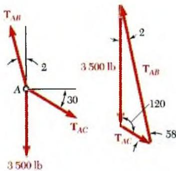
**Diagrama de cuerpo libre.** Se escoge el punto A como cuerpo libre y se dibuja el diagrama completo de cuerpo libre.  $T_{AB}$  es la tensión en el cable AB y  $T_{AC}$  es la tensión de la cuerda.
