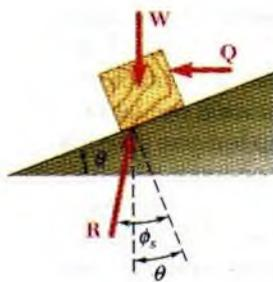
b) Movimiento inminente hacia abajo con  $\phi_s > \theta$
