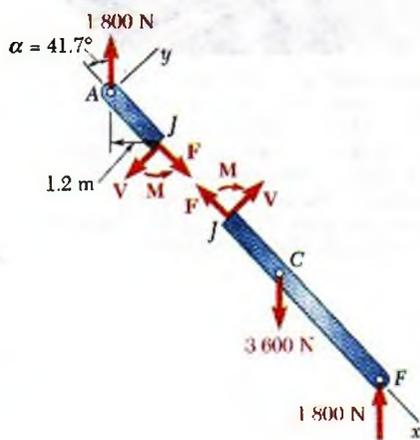
a) **Fuerzas internas en J.** Se corta el elemento ACF en el punto J y se obtienen las dos partes que se muestran en la figura. Las fuerzas internas en J están representadas por un sistema equivalente fuerza-par y se determinan al calcular el equilibrio de cualquiera de las partes en que ha sido dividido el elemento. Si se considera el *diagrama de cuerpo libre* AJ, se escribe
