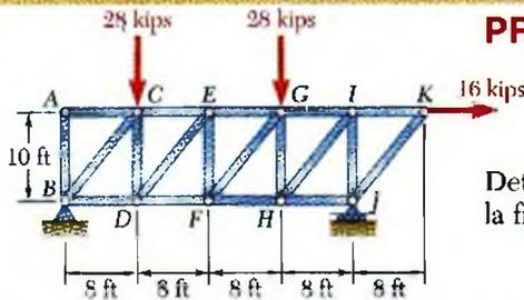
Determine la fuerza en los elementos  $EF$  y  $GI$  de la armadura mostrada en la figura.
