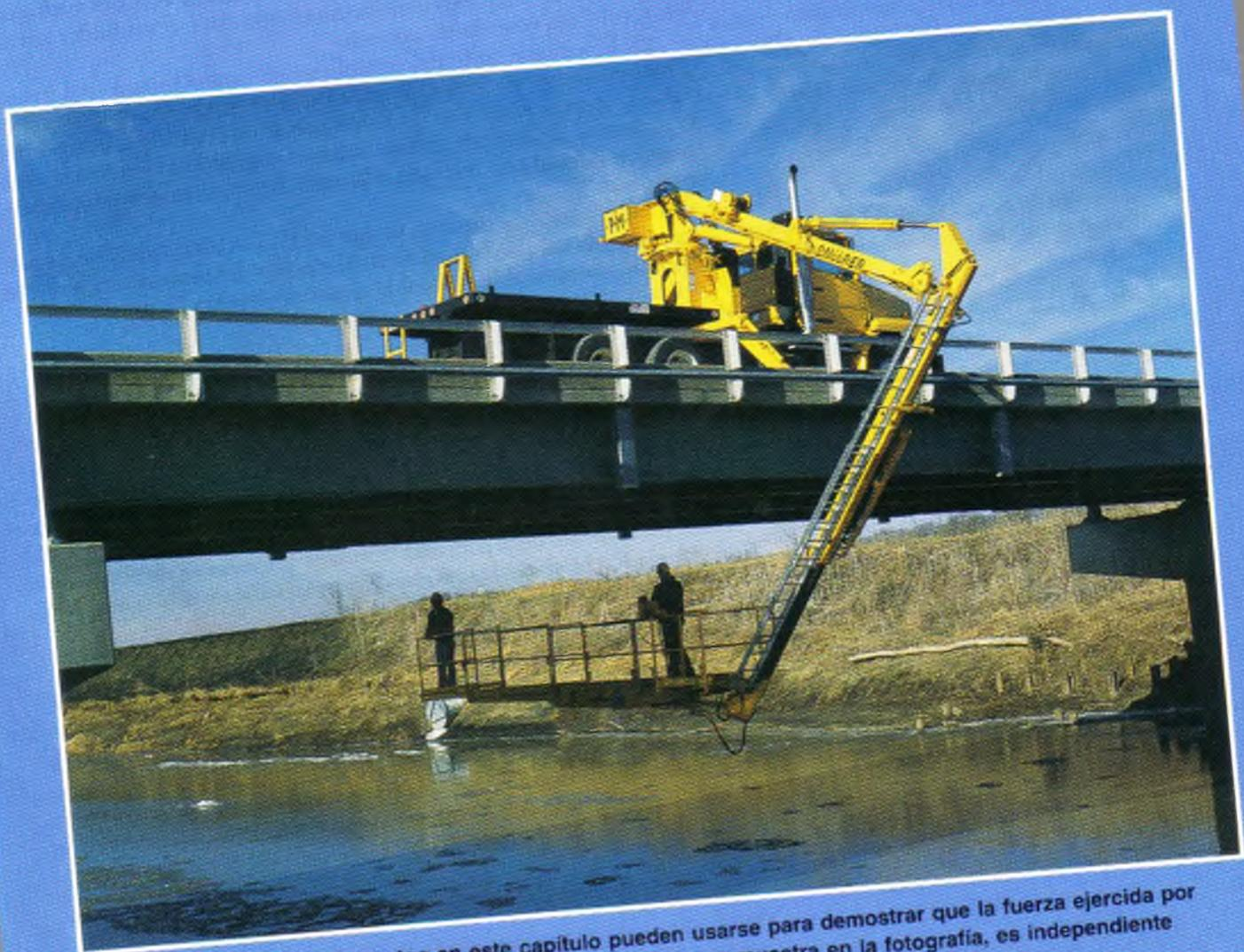
Los métodos analíticos expuestos en este capítulo pueden usarse para demostrar que la fuerza ejercida por el cilindro hidráulico, mientras levanta o baja el aguilón que se muestra en la fotografía, es independiente de la ubicación de los trabajadores sobre la plataforma.
