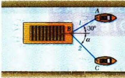
Un lanchón es arrastrado por dos remolcadores. Si la resultante de las fuerzas ejercidas por los remolcadores es una fuerza de 5 000 lb dirigida a lo largo del eje del lanchón, determine: a) la tensión en cada una de las cuerdas, sabiendo que  $\alpha = 45^\circ$ , y b) el valor de  $\alpha$  tal que la tensión en la cuerda 2 sea mínima.
