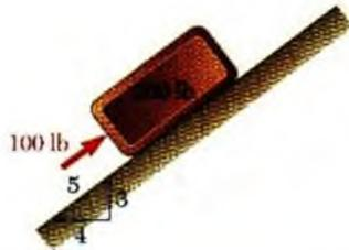
Como se muestra en la figura, una fuerza de 100 lb actúa sobre un bloque de 300 lb que está colocado sobre un plano inclinado. Los coeficientes de fricción entre el bloque y el plano son  $\mu_s = 0.25$  y  $\mu_k = 0.20$ . Determine si el bloque está en equilibrio y encuentre el valor de la fuerza de fricción.
