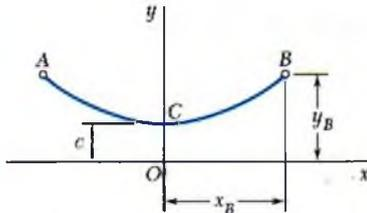
**Ecuación del cable.** El origen de las coordenadas se coloca a una distancia  $c$  por debajo del punto más bajo del cable. De esta forma, la ecuación del cable está dada por la ecuación (7.16),
