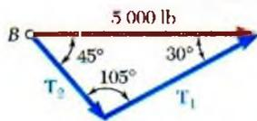
*Solución trigonométrica.* Puede usarse la regla del triángulo. Obsérvese que el triángulo mostrado representa la mitad del paralelogramo que se presenta antes. Si se emplea la ley de los senos, se escribe
