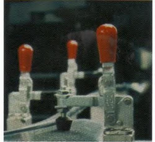
**Fotografía 10.2** La fuerza de agarre de la abrazadera de seguro que se presenta en la fotografía puede ser expresada como una función de la fuerza aplicada a la manivela, estableciendo primero las relaciones geométricas entre los elementos de la abrazadera, para después aplicar el método del trabajo virtual.
