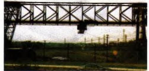
Fotografía 6.2 Dos armaduras K se usaron como los principales componentes del puente móvil que se muestra en la foto, el cual se movía por encima de un gran montón de mineral de reserva. El cubo que se encuentra debajo de las armaduras levantaba mineral y lo redepositaba hasta que el mineral estuvo completamente mezclado. Después, el mineral se envió el molino para incorporarlo a un proceso de producción de acero.
