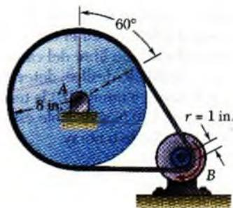
Una banda plana conecta una polea A que mueve una máquina herramienta, con una polea B, la cual está unida a la flecha de un motor eléctrico. Los coeficientes de fricción entre ambas poleas y la banda son  $\mu_s = 0.25$  y  $\mu_k = 0.20$ . Si se sabe que la tensión máxima permisible en la banda es de 600 lb, determine el momento torsional máximo que puede ejercer la banda sobre la polea A.
