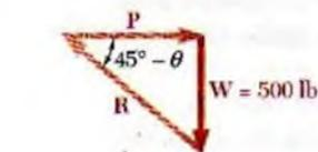
**c) Fuerza horizontal  $P$  para comenzar a levantar la carga.** Como las tres fuerzas  $W$ ,  $P$  y  $R$  no son paralelas, éstas deben ser concurrentes. Por tanto, la dirección de  $R$  se determina a partir del hecho de que su línea de acción debe pasar a través del punto de intersección  $D$  de las líneas de acción de  $W$  y  $P$  y debe ser tangente al círculo de fricción. Si recordamos que el radio del círculo de fricción es  $r_f = 0.20 \text{ in.}$ , se escribe
