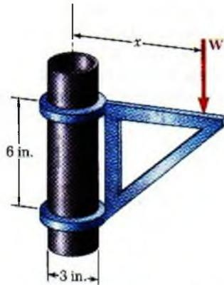
La ménsula móvil que se muestra en la figura puede colocarse a cualquier altura a lo largo del tubo de 3 in. de diámetro. Si el coeficiente de fricción estática entre el tubo y la ménsula es de 0.25, determine la distancia mínima  $x$  a la cual se puede soportar la carga  $W$ , sin tomar en cuenta el peso de la ménsula.
