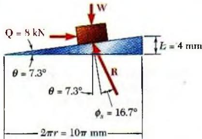
**a) Fuerza ejercida por la prensa.** El radio promedio del tornillo es  $r = 5 \text{ mm}$ . Como el tornillo es de rosca doble, el avance  $L$  es igual al doble del paso:  $L = 2(2 \text{ mm}) = 4 \text{ mm}$ . El ángulo de avance  $\theta$  y el ángulo de fricción  $\phi_s$ , se obtienen escribiendo
