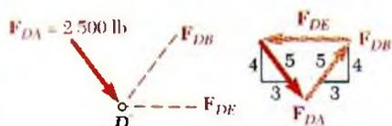
**Cuerpo libre: nodo D.** Como la fuerza ejercida por el elemento AD ya se determinó, ahora sólo se tienen dos incógnitas involucradas con este nodo. De nuevo se usa un triángulo de fuerzas para determinar las fuerzas desconocidas en los elementos DB y DE.
