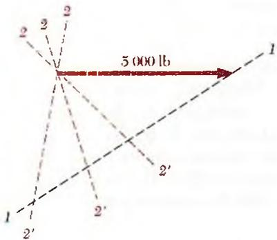
b) **Valor de  $\alpha$  para  $T_2$  mínima.** Para determinar el valor de  $\alpha$  que la tensión de la cuerda 2 sea mínima se usa otra vez la regla del triángulo. En el esquema mostrado, la línea  $l-l'$  es la dirección de  $T_1$ . Las líneas  $2-2'$  indican varias direcciones posibles de  $T_2$ . Observe que el mínimo valor de  $T_2$  ocurre cuando  $T_1$  y  $T_2$  son perpendiculares. El valor mínimo de  $T_2$  es
