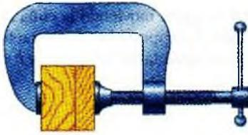
Una prensa se utiliza para mantener juntas dos piezas de madera, como se muestra en la figura. La prensa tiene una rosca cuadrada doble cuyo diámetro medio es igual a 10 mm y cuyo paso es de 2 mm. El coeficiente de fricción entre las roscas es  $\mu_s = 0.30$ . Si se aplica un momento torsional máximo de  $40 \text{ N} \cdot \text{m}$  al apretar la prensa, determine: *a)* la fuerza ejercida sobre las piezas de madera y *b)* el momento torsional requerido para aflojar la prensa.
