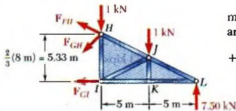
**Fuerza en el elemento  $FH$ .** El valor de  $F_{FH}$  se obtiene a partir de la ecuación  $\Sigma M_G = 0$ . Se mueve  $F_{FH}$  a lo largo de su línea de acción hasta que actúe en el punto  $F$ , donde se descompone en sus componentes  $x$  y  $y$ . Ahora, el momento de  $F_{FH}$  con respecto al punto  $G$  es igual a  $(F_{FH} \cos \alpha)(8 \text{ m})$ .
