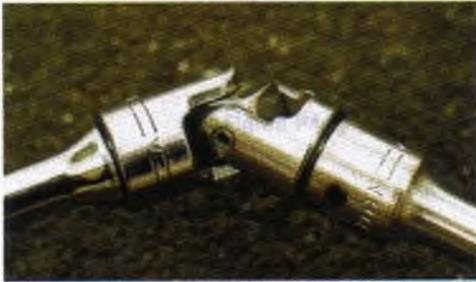
**Fotografía 4.6** Las juntas universales que se encuentran comúnmente en las flechas motrices de los autos y camiones de tracción trasera, permiten la transmisión del movimiento rotacional entre dos ejes no colineales.
