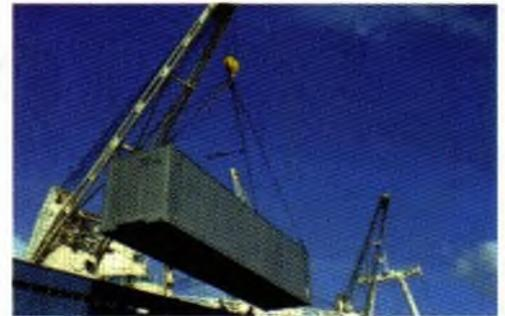
**Fotografía 2.3** Como la tensión presente en los cuatro cables que sostienen al contenedor de carga no se puede encontrar mediante las tres ecuaciones (2.34), es posible obtener una relación entre las tensiones considerando el equilibrio del gancho.
