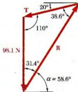
**Triángulo de fuerzas.** Se dibuja un triángulo de fuerzas, como se muestra en la figura y se calculan sus ángulos interiores a partir de las direcciones conocidas de las fuerzas. Con el uso de la ley de los senos se escribe
