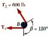
**Polea B.** Con el uso de la ecuación (8.14) con  $T_2 = 600$  lb,  $\mu_s = 0.25$  y  $\beta = 120^\circ = 2\pi/3$  rad, se escribe
