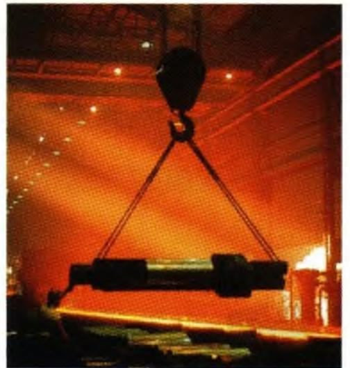
**Fotografía 2.2** Como se ilustró en un ejemplo anterior, es posible determinar las tensiones en los cables que sostienen al eje que se muestra en la fotografía, considerando al gancho como una partícula y después aplicando las ecuaciones de equilibrio a las fuerzas que actúan sobre el gancho.
