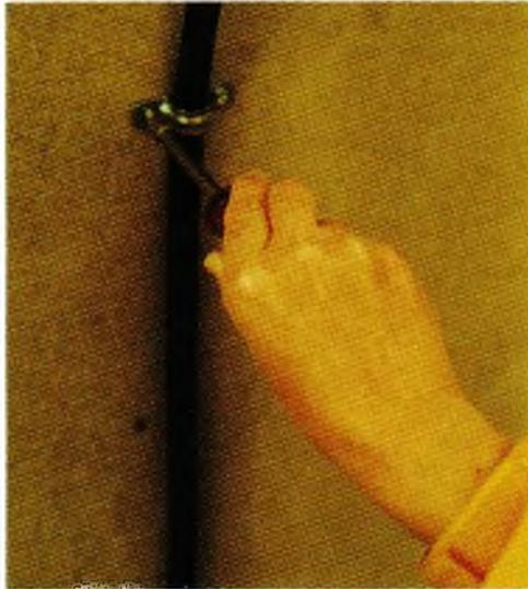
**Fotografía 3.6** La acción de empujar y girar, asociadas con la operación de apretar un tornillo ilustra las líneas de acción colineales de la fuerza y el vector de par que constituyen una llave de torsión o torsor.
