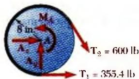
**Polea A.** Se dibuja el diagrama de cuerpo libre de la polea A. El par  $M_A$  se aplica a la polea por la máquina herramienta a la cual está unida la polea y es igual y opuesto al momento torsional ejercido por la banda. Así se escribe
