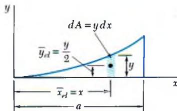
**Elemento diferencial vertical.** Se selecciona el elemento diferencial mostrado y se determina el área total de la figura.
