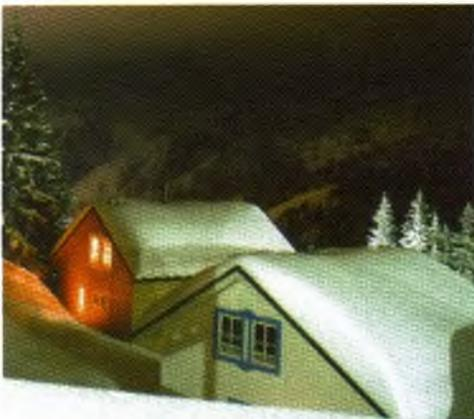
**Fotografía 5.3** Los techos de las construcciones que se muestran en la fotografía pueden ser capaces de soportar no sólo el peso de la nieve, sino también las cargas distribuidas no simétricas causadas por el amontonamiento de la nieve.
