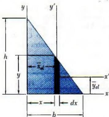
b) **Producto de inercia  $\bar{I}_{x'y''}$ .** Las coordenadas del centroide del triángulo con respecto a los ejes  $x$  y  $y$  son
