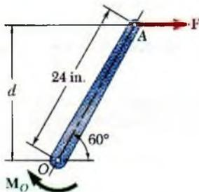
**c) Fuerza mínima.** Como  $M_O = Fd$ , el mínimo valor de  $F$  se obtiene cuando  $d$  es máximo. Se selecciona la fuerza perpendicular a  $OA$  y se observa que  $d = 24 \text{ in.}$ ; entonces
