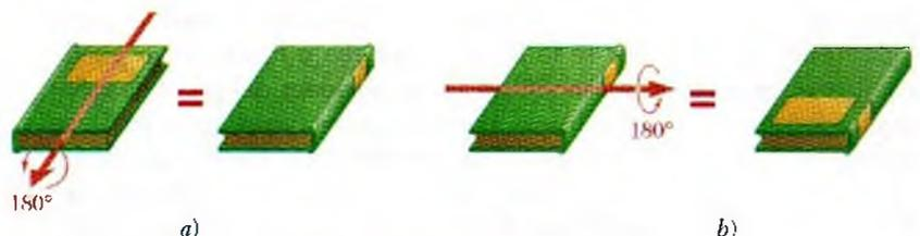
Figura 2.3 Rotaciones finitas de un cuerpo rígido
