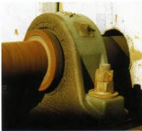
**Fotografía 4.7** La caja de cojinetes que se muestra en la fotografía sostiene al eje de un ventilador usado en un taller de fundición.
