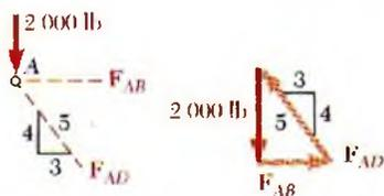
**Cuerpo libre: nodo A.** El nodo sujeto a dos fuerzas desconocidas, esto es, a las fuerzas ejercidas por los elementos AB y AD. Se usa un triángulo de fuerzas para determinar  $F_{AB}$  y  $F_{AD}$ . Se observa que el elemento AB jala al nodo y, por tanto, dicho elemento está en tensión. Además, el elemento AD empuja al nodo y, por tanto, dicho elemento está en compresión. Las magnitudes de las dos fuerzas se obtienen a partir de la proporción
