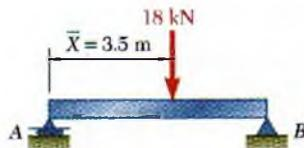
Por tanto,  $\bar{X}\Sigma A = \Sigma \bar{x}A$ :  $\bar{X}(18 \text{ kN}) = 63 \text{ kN} \cdot \text{m}$   $\bar{X} = 3.5 \text{ m}$
