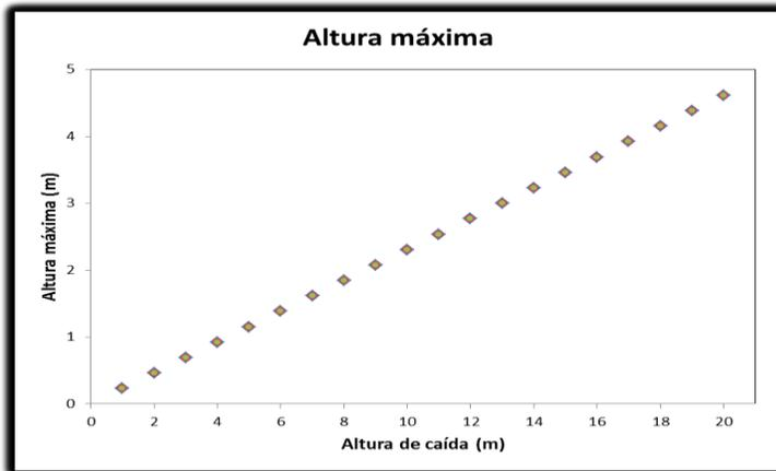
Gráfico de la altura máxima alcanzada después de rebotar contra el resorte en función de la altura de caída
