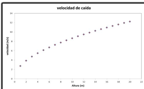
Gráfico de la velocidad con la que llega el ascensor al extremo del resorte en función de la altura de caída
